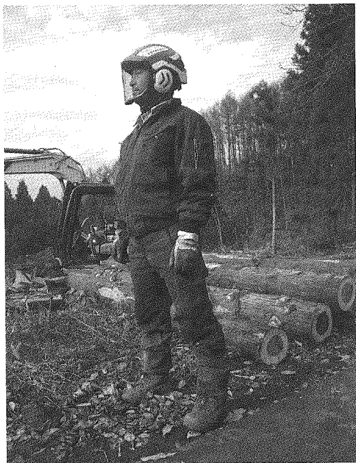
ヘルメットはフェイスガードとイヤマフ付きのもの、防護ズボン、安全靴・安全ブーツを支給した
